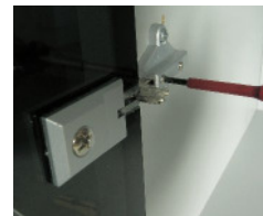
20. Türhalter in Schrank einschrauben
