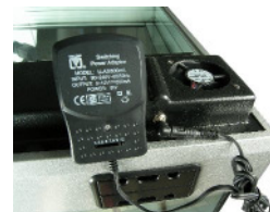
22. Trafo für Lüfter anbringen. Verpolung beachten. Trafo regelbar.
